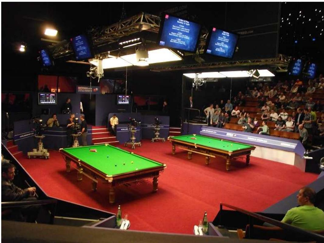
O kvalitetu osvetljenja (Osram) suvišno je trošiti reči. Vidi se da se uz svetiljke glavnog osvetljenja (kombinacija fluorescentnih sijalica i halogenih sijalica) nalaze i daunlajteri, kao ipokretni reflektori za pomoćne TV kamere.
