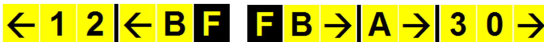
Слика 8. Информативни осветљени знаци на изласку према рулним стазама Б (TWY B) и А (TWY A)
