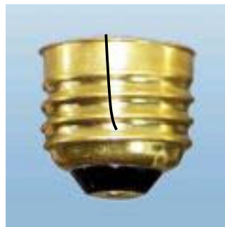
Slika 3. Izgled napuklog mesinganog podnoška usled interkristalne korozije.
