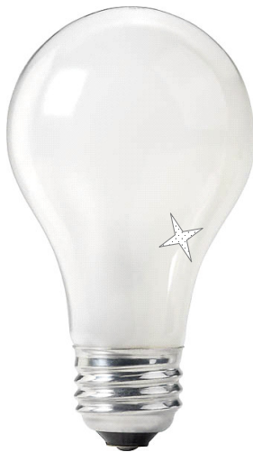
Slika 1. Izgled pahuljastih mrlja na balonu sijalice i na cevi. Mrlje su nesrazmerno uvećane kako bi se prikazao njihov oblik.
