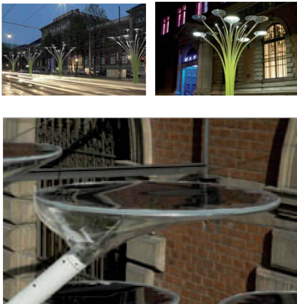
Слика 7.2 Соларно дрвеће као инсталација уличног осветљења
